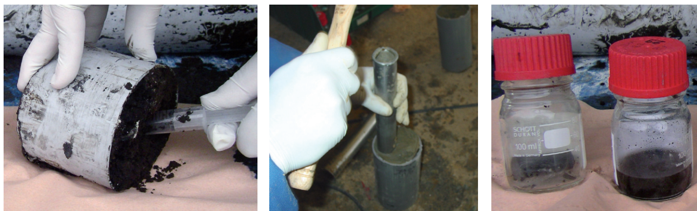
Figure 3 : Prélèvement de sols à l'aide d'un emporte-pièce (PET à gauche, inox à droite) et extraction au méthanol sur site – Méthode 1.
